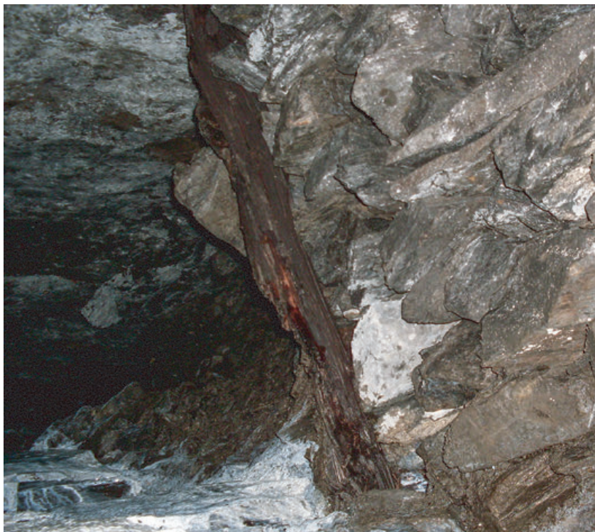
Abb. 5: Abgebauter Erzgang mit Handversatz (rechts) und Erzrolle mit Carbonatausfällungen (links).
