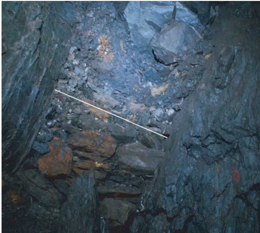
Abb. 4: Untere Lahn-Revier – abgebauter Erzgang (weiße Linie) mit Versatz.
