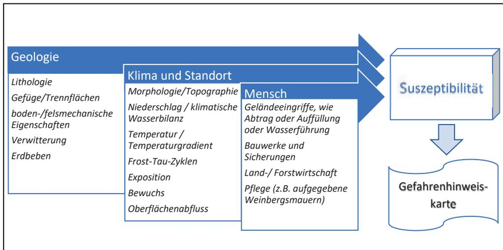
Abb. 19: Schematische Darstellung einer möglichen Suszeptibilitätsanalyse von Hangbereichen in Rheinland-Pfalz. Weiterhin sind die verschiedenen Faktoren, die die Gefahr durch Massenbewegungen beeinflussen, zusammengestellt.
