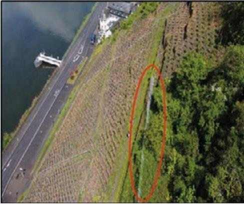
Abb. 10: Drohnenaufnahme des Westhangs des Burgbergs mit eingekreistem Steinschlagfangzaun auf halber Hanghöhe.
