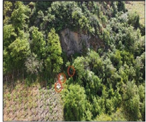
Abb. 11: Drohnenaufnahme der offenen Felspartie unterhalb der Burg Metternich mit eingekreisten „Stummen Zeugen“ (Relikte früherer Steinschläge/Felsstürze).
