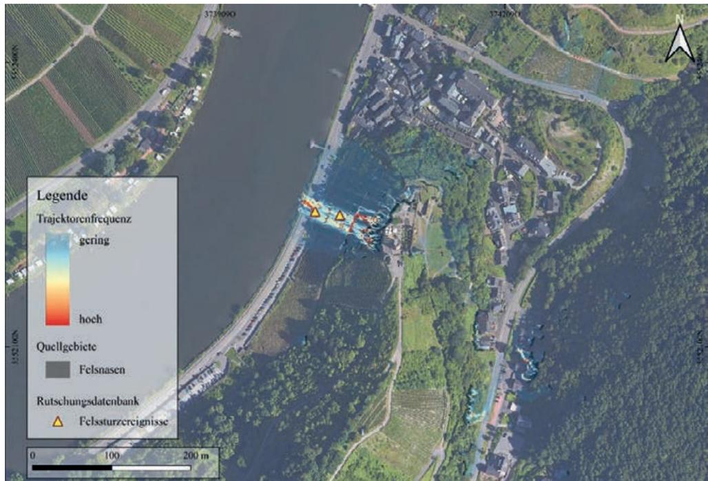
Abb. 9: Steinschlagmodellierung des Burgbergs bei Beilstein mit eingezeichneten Schadensfällen der Rutschungsdatenbank Rheinland-Pfalz.
