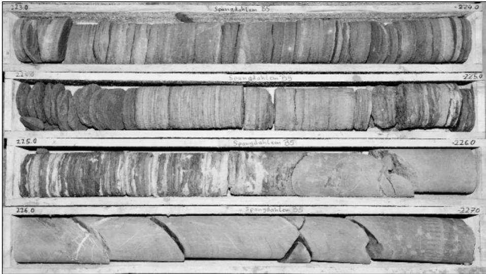
Abb. 3: Winkeldiskordante Auflagerung von Mittlerem Buntsandstein auf gefaltetem unterdevonischem Grundgebirge (Spangdahlem TB 5, Profilmeter 223 bis 227 m).
