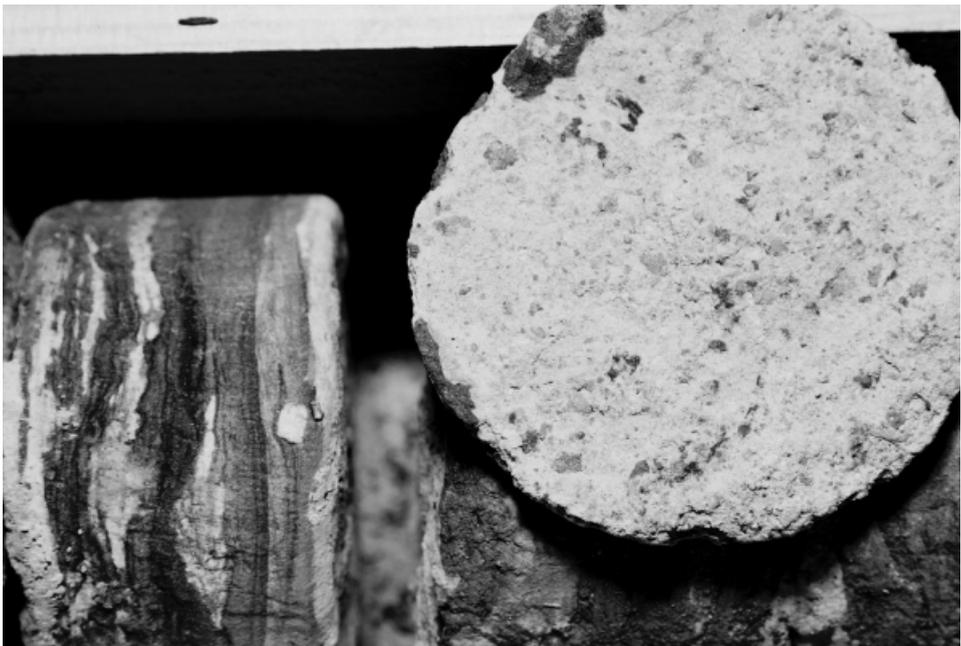
Abb. 4: Geröll-Lage und kantiges Einzelgeröll in der niederenergetischen Basalkonglomerat-Vertretung der Spangdahlem-Bohrung TB 5 (bei 225,25 bis 225,30 m).
