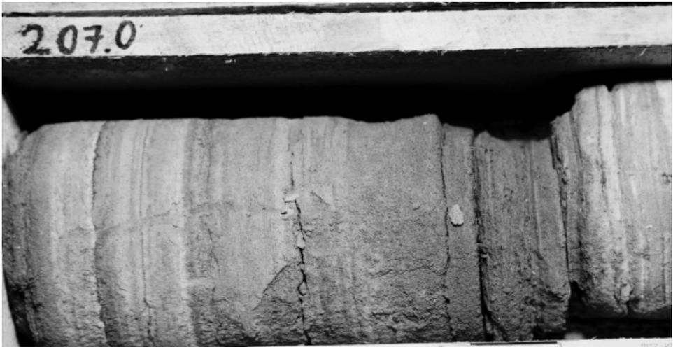
Abb. 7: Feinschichtige Sedimentabfolge in den Densborn-Schichten (Spangdahlem TB 5, Teufe 207,00 bis 207,20 m).
