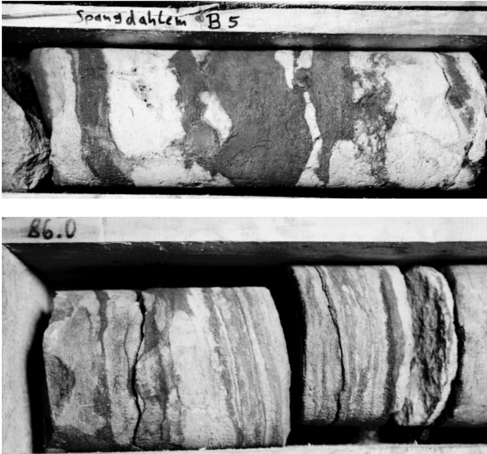
Abb. 10: Faziesbeispiele der Violettschichten (Spangdahlem TB 5). Oben: Profilabschnitt von 83,50 bis 83,85 m Teufe (rechts). Es erscheinen weißliche Dolomitzementen, mit kleinen Drusen bei 83,60 m, in ockerroten, blauvioletten und graublauen, etwas tonigen Sandsteinen. Unten: Profilabschnitt von 86,00 bis 86,25 m Teufe (rechts). Der blassrotbraune Sandstein ist durchsetzt mit unregelmäßig verteilten Dolomitzementen, mit dünnen Dolomitzementen und mit Dolomitzementen.
