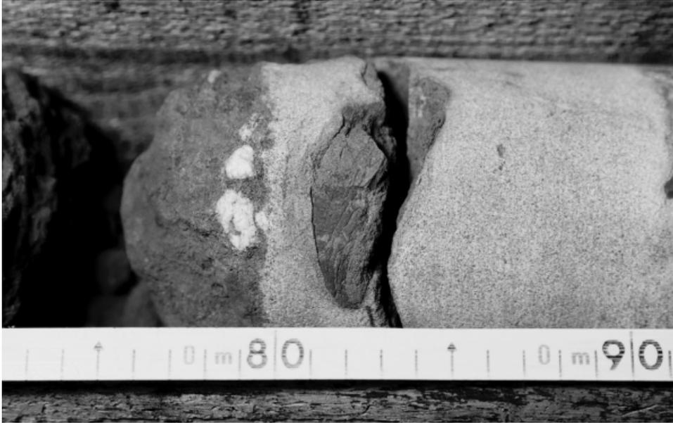
Abb. 20: Geröleinlagerung in den Malbergweich-Schichten im Spangdahlem-Kernprofil TB 13 (Teufe ca. 38,75 m bis 38,80 m). In tonig-siltiger Matrix liegen bis 2 cm große Milchquarzgerölle. Darunter ist noch der Top eines harten Fein-Mittelsandsteins zu sehen, der große (bis 6,5 cm) kantengerundete Tonsteingerölle führt.
