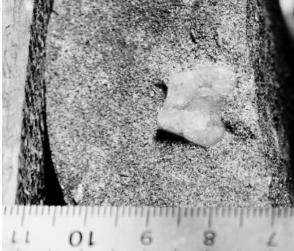
Abb. 19: Eckig-kantengerundetes Quarzgeröll, ca. 1,5 cm groß, in einem sVGS-Sandstein der Spangdahlem-Bohrung TB 18; Teufe 56,85 m.
