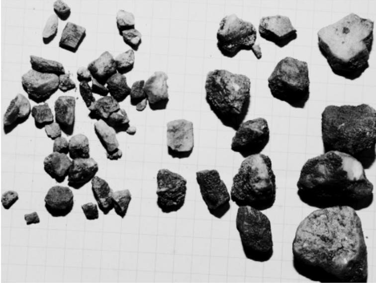
Abb. 18: Streuprobe der eckig-kantengerundeten Milchquarzgerölle in der höheren Konglomeratischen Serie der Spangdahlem-Bohrung TB 13, etwa bei 81,35 m Teufe.
