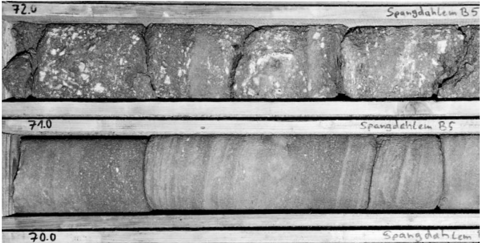
Abb. 11: Sandsteine und Konglomerate der Konglomeratischen Serie im Spangdahlem-Profil TB 5 (Teufenbereiche 72,00 bis 72,60 m und 71,00 bis 71,60 m). Die Gesteine sind hier weitgehend dolomittfrei und orangestichig fahlrot und rotgrau gefärbt. Die Sandsteine zeigen hier eine vergleichsweise deutliche Schrägschichtung.
