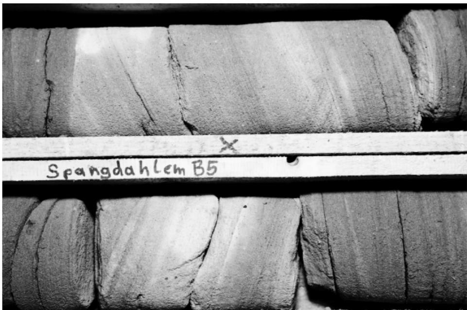
Abb. 8: Wahrscheinlich äolisch abgelagerte Sandsteinpartien in den unteren Densborn-Schichten (Spangdahlem TB 5: um 197,50 m und 198,50 m). Nähere Erläuterungen im Text.
