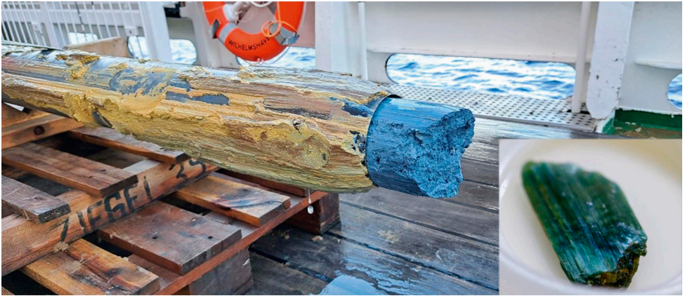
Abb. 4: Serpentin-Sedimentkern, der während der SONNE-292/2-Expedition mit einem Schwerelot entnommen wurde, mit einem Stück eines cm-großen Serpentinits unten rechts (Foto: W. Menapace)
