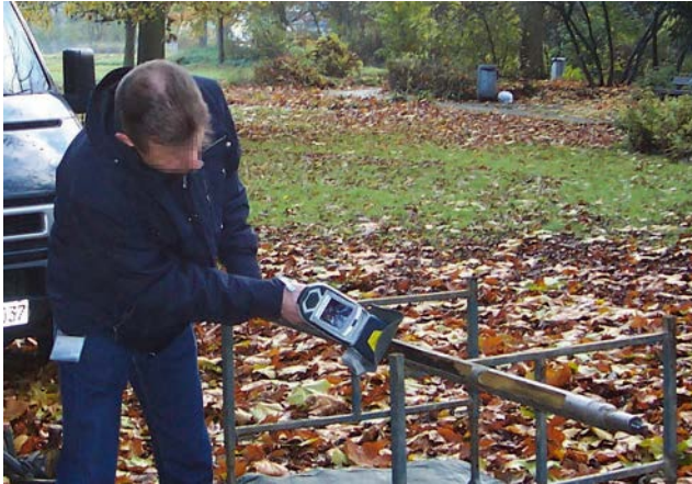
Abbildung 2: Direktmessung des Bleigehalts an Bodenproben an einer Rammkernschuppe mit dem tRFA
