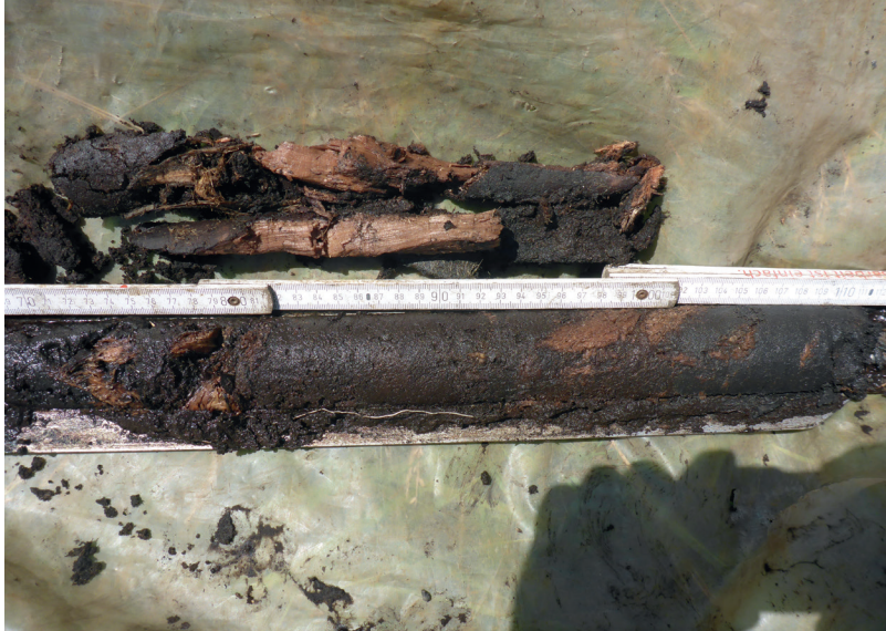
Abb. 9: Erlenbruchwald-Torf in Bohrung L4, Tiefe: 70-110 cm (Basis rechts, Foto vom 06.07.21). Alder carr peat in coring L4, depth: 70-110 cm (basis on the right side, photo 2021/07/06).
