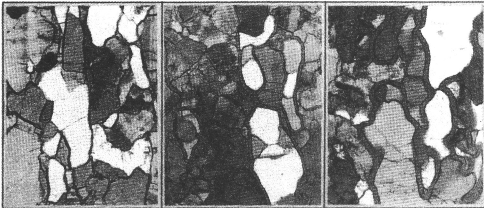
Abb. 6.8: Zeitsequenz einer Gneisprobe unter Druck (200 MPa) und Temperatur (760°C) für (von links nach rechts) 1h, 1 Tag, 3 Tage. Die dunklen Linien an den Korngrenzen zeigen die Schmelze in Kontaktbereich (Mehnert et al. 1973).
