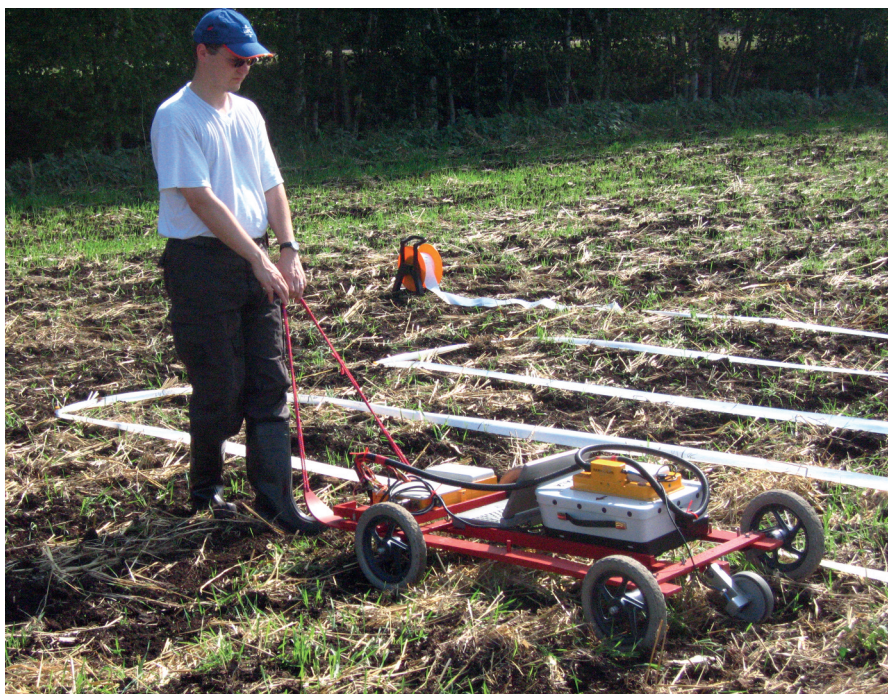
Abb. 3: Einsatz von Georadar bei der Prospektion in Mooren. Ground penetrating radar for archaeological prospection in peatlands.
