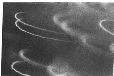
Abb. 2: Aufnahme des Kondensations-Verdampfungs-Zyklus an Einzelteilchen. (Umlaufsinn entgegengesetzt zu dem in Abb. 1).
