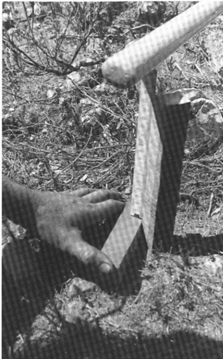
Photo 1: Meßpegelanordnung in den Meßreihen A-J, Meßpegel: 3 x 3 cm Kantenlänge, 35 cm Gesamtlänge. Lokalität: Meßreihe B (HW 5277/RW 4610).
