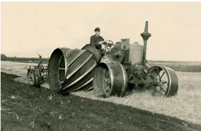
Abb. 2: Landbaumaschine mit Moorbereitung beim Pflügen einer Moorfläche in der Esterweger Dose um 1927. (Archiv Torfwerk Moorkultur Ramsloh). Agricultural machinery with bog tyres ploughing peatland in Esterweger Dose around 1927. (Archive of the Moorkultur Ramsloh peatworks).
