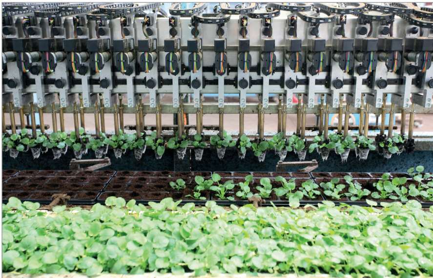
Abb. 5: Pikierroboter beim Umsetzen von Stiefmütterchen in größere Einheiten (Foto: KLASMANN-DEILMANN GMBH). Robots transplanting pansies into larger modules for growing on (Photo: KLASMANN-DEILMANN GMBH).
