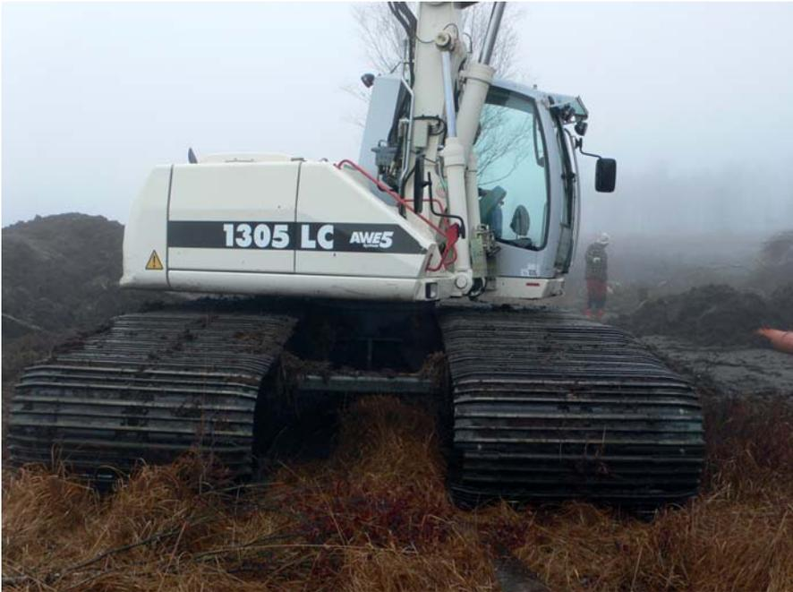
Abb. 6: Bagger mit verbreiterten und verlängerten Kettenlaufwerken zum Einsatz im Moor beim Einbau von Überlaufrohren im Mecklenbruch
