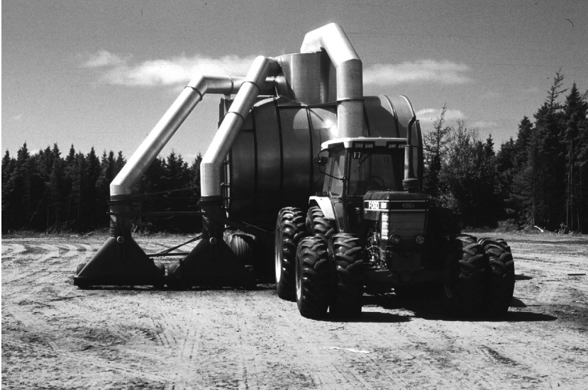
Abb. 3: Vakuum-Sauger zur Gewinnung von getrocknetem Frästorf Vacuum extractor sucking up dried milled peat
