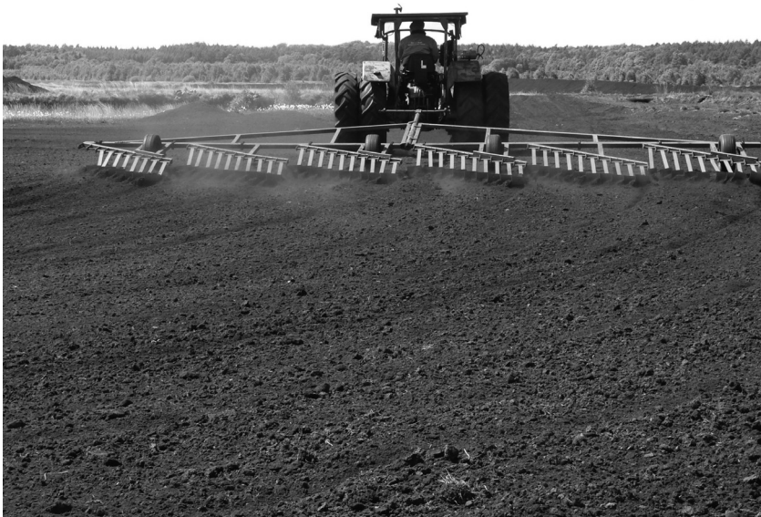
Abb. 2: Wenden des Torfes zur weiteren Trocknung im Frästorferverfahren. Milled peat production: turning the peat for further drying.
