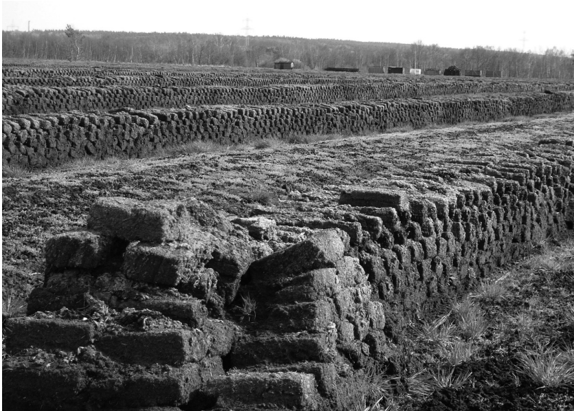
Abb. 1: Abbau von Hochmoorgrünland im Stechtorf-Verfahren. Peat extracted as sods from raised peat bog grassland.
