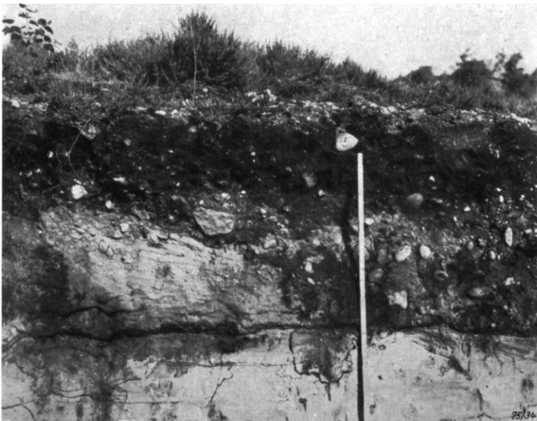
Figur 2. Zutage tretende Grundmoräne, durch Verwitterung der oberen Schichten in Geschiebedecksand umgewandelt, in den unteren z.T. noch als bindiger Geschiebelehm erhalten. Aufschluß im Forst von Hopels (Blatt Wiesede).
