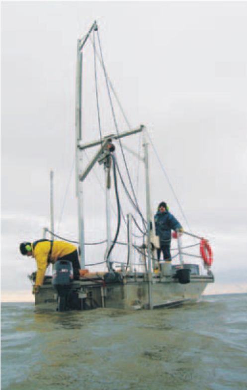
Bohrarbeiten auf der Bohrplattform „Bohrbo“ (freundliche Leihgabe des FTZ Büsum der Universität Kiel) im zentralen Jadebusengebiet (Foto: W. Wartenberg)
