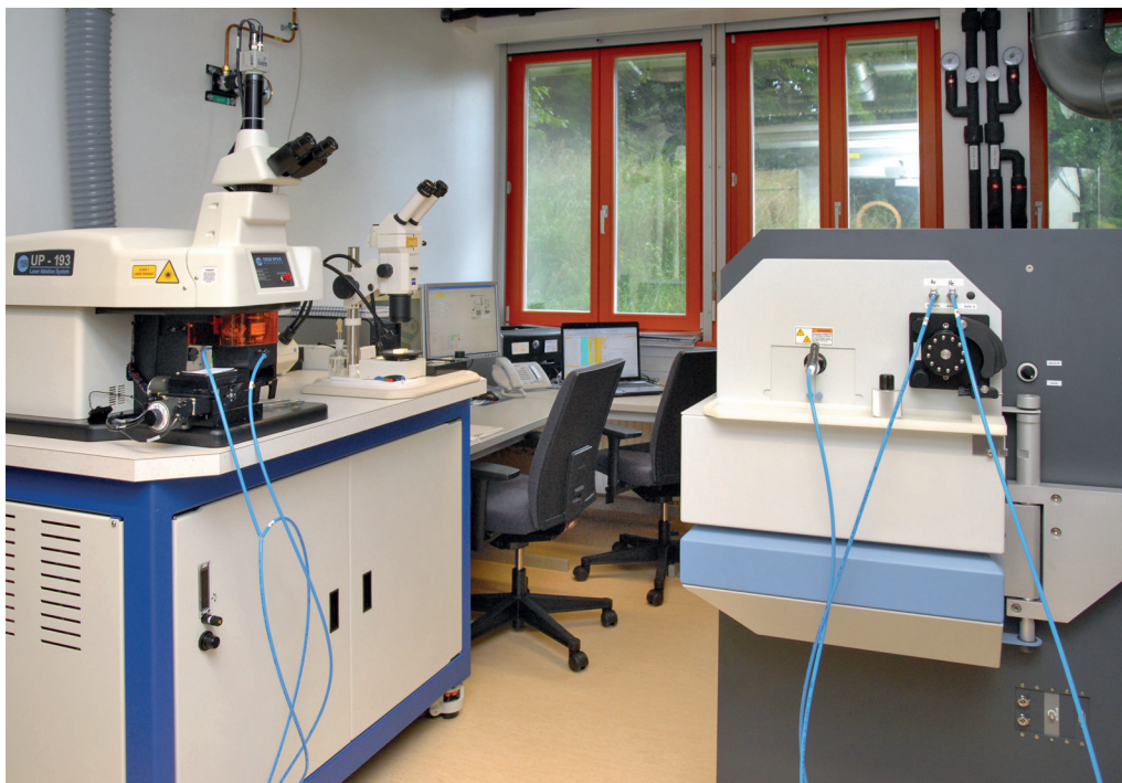
Abb. 11: Geochronologielabor der SNSD. Links befindet sich ein Excimer-Laser (UP 193, New Wave), rechts ist die ICP-MS (ELEMENT 2 XR, Fisher Scientific) zu erkennen. Foto: Ulf-Gerhard Linnemann
