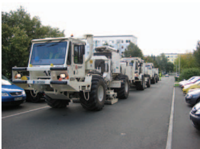
Abb. 1: Vibratorkolonne in Schneeberg. Nach ca. 2–3 min Vibrationstätigkeit fährt die Kolonne 30 m weiter bis zum nächsten Vibratorpunkt.
