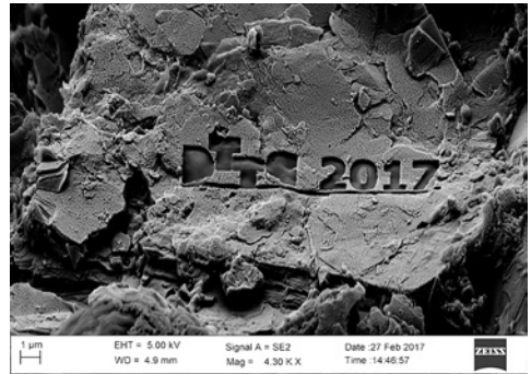
FIB-Gravur am Posidonienschiefer aus der Hilsmulde (Aufnahme und Design von Markus Peltz)
