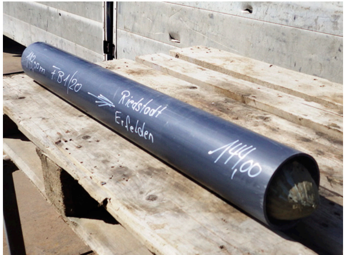
Bohrplatz und Liner aus dem Tiefenbereich von 143 bis 144 m der Forschungsbohrung bei Riedstadt-Erfelden (Fotos: C. Hoeselmann)
