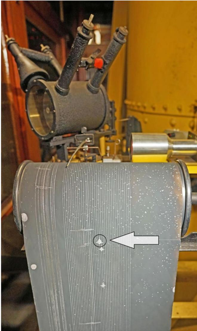
Abb. 2: Registrierung der Bombensprengungen mit der Nord-Süd-Komponente des 17-t-Pendels auf berußtem Papier, das für den Vergleich genutzte dritte Ereignis wurde markiert (oberes „Tannenbäumchen“; Foto: U. Wedeken)
