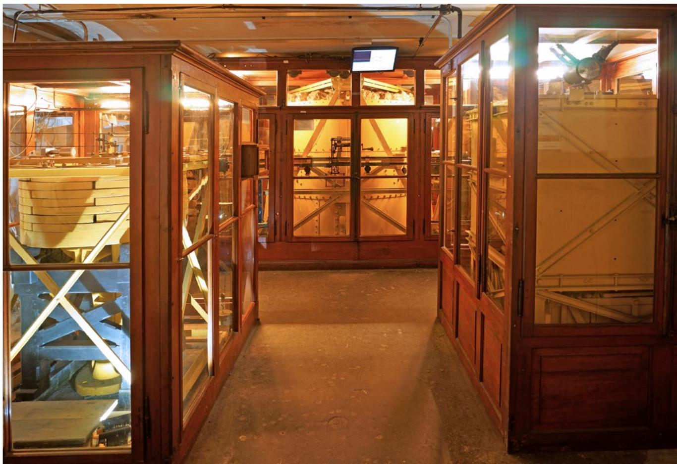
Abb. 1: Blick von der letzten der vier Eingangstüren auf die Wiechert-Seismographen: Astaticher Horizontal-Seismograph (links), 17-t-Pendel (Mitte), Vertikal-Seismograph (rechts); Foto: U. Wedeken
