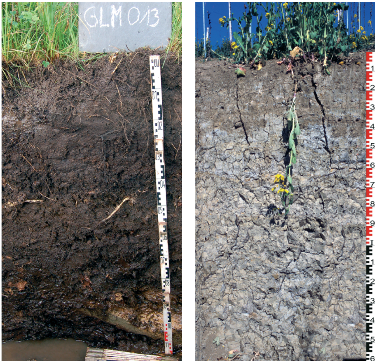
Abb. 6: Moorboden aus Niedermoor, Landstuhler Bruch bei Hütschenhausen (links), Tonboden mit Trockenrissen (Pelosol aus Tonmergel), Stackeden-Elsheim (rechts).
