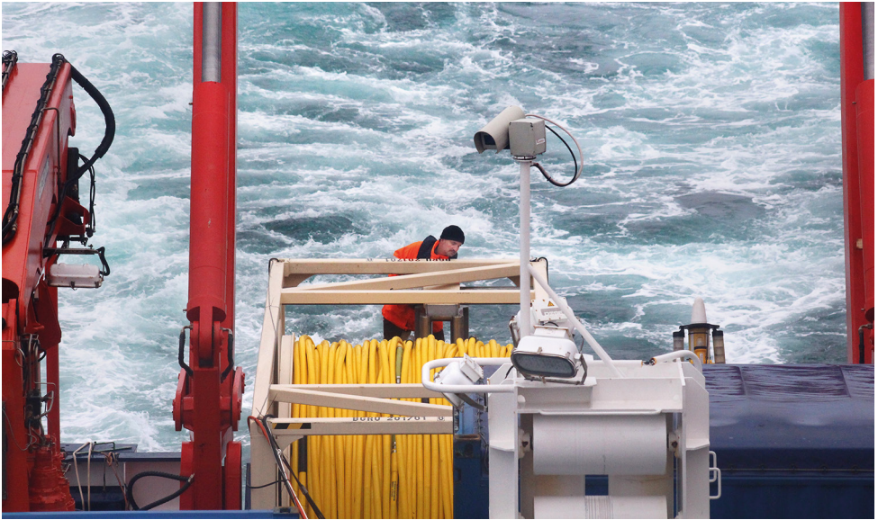
Abb. 4: Blick auf das Achterdeck des Forschungsschiffes Maria S. Merian während der Forschungsfahrt vor Ostgrönland. Auf der Streamerwinde ist das gelbe Messkabel (Streamer) aufgetrommelt. In diesem Messkabel befinden sich die Hydrophone, eingebettet in einen stabilen syntaktischen Schaum. Das Vorgängermodell des Streamers bestand noch aus einem ölgefüllten Schlauch, der jedoch sehr anfällig für Beschädigungen war und mehr Störgeräusche aufzeichnete. (Foto: BGR)
