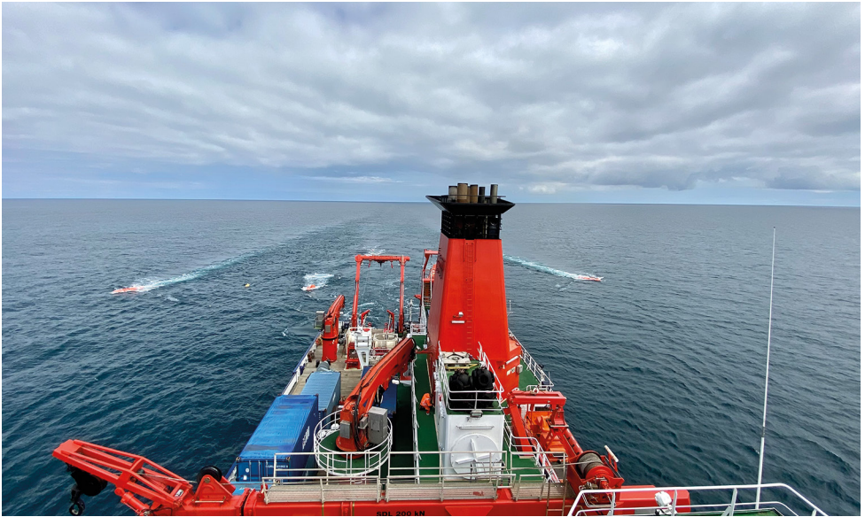
Abb. 10: 3D-Messung in der Nordsee an Bord Maria S. Merian (Foto: BGR)
