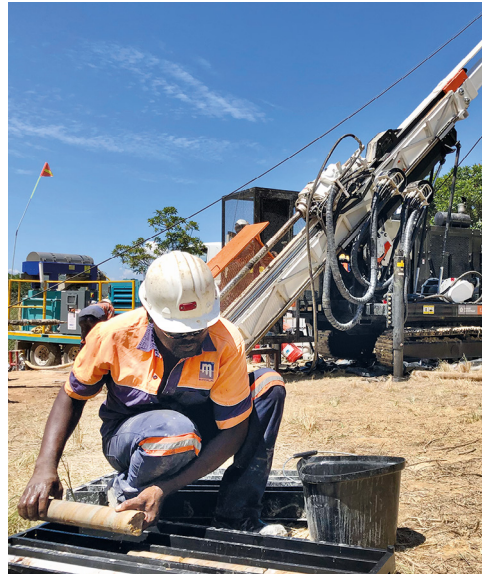
Bohrkerngewinnung am Bohrplatz 2, etwa 6 km von Barberton im Grünsteingürtel gelegen. Die Bohrung durchteufte Sandsteine und Konglomerate einer fluviatilen Küstenebene, überlagert von Aridisols, mikrobiellen Matten in Sandsteinen und wechselgelagerten tuffig-sandigen Ästuarfüllungen (Foto: C. Heubeck).
