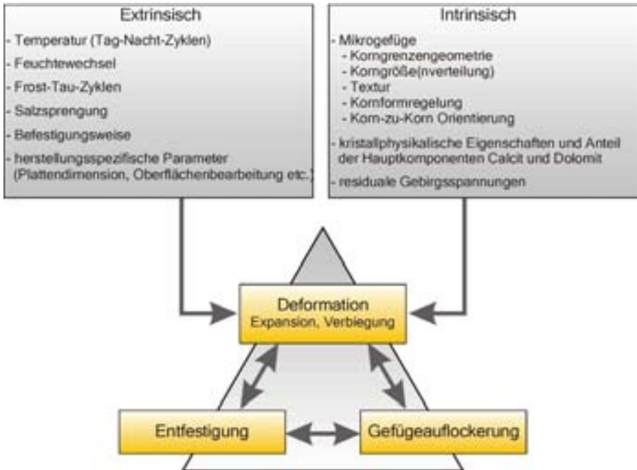
Abb. 2.9: Grundschemata des Zusammenwirkens von Einflussparametern auf die Verwitterung von Marmorplatten.
