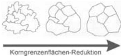
Abb. 2.6: Schematische Darstellung des Prozesses der Korngrenzenflächenreduktion. Unter Glättung irregulärer Korngrenzen und Kornwachstum bildet sich ein polygonales Korngefüge heraus (aus Passchier & Trouw 1996).
