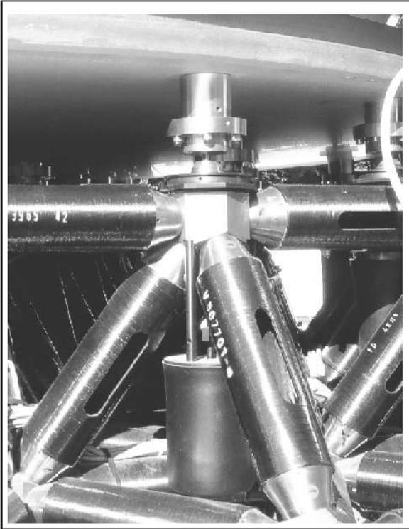
Abbildung 2.1: Spiegel, Aktuator und CFK-Zelle
