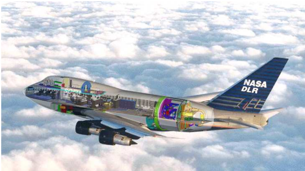
Abbildung 2.1: Das Stratospheric Observatory for Far-Infrared Astronomy - SOFIA. Die Teleskopstruktur ist im hinteren Teil des Rumpfes zwischen Tragflächen und Höhenleitwerk in blau zu erkennen. Ein Druckschott ( violett ) trennt die Kabine vom Teleskopraum. Vor dem Druckschott, im Vorderteil des Flugzeuges, befindet sich der Kontrollraum. Im Flugzeugbug ist der Präsentationsraum zu erkennen, in dem Gäste während eines Messfluges den wissenschaftlichen Betrieb mitverfolgen können. Quelle: USRA.
