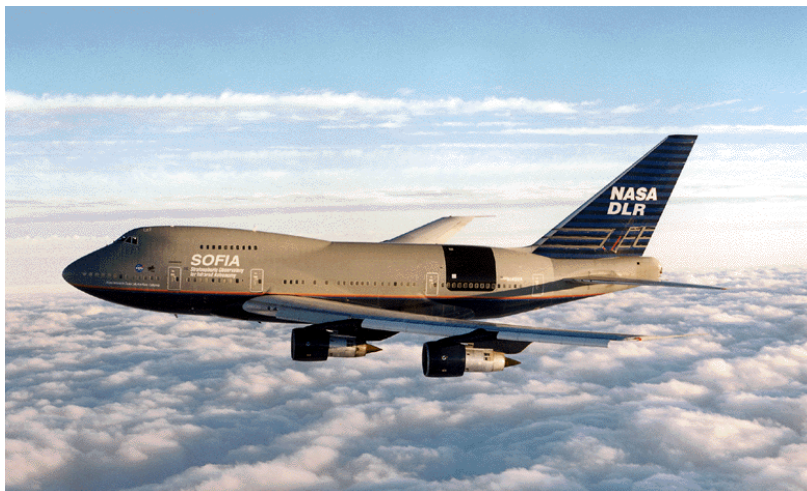
Abb.1: Das SOFIA-Flugzeug vor dem Umbau. Die schwarze Markierung am Flugzeugrumpf hinter den Triebwerken zeigt die Stelle an, an welcher mittlerweile die Teleskoptür eingebaut wurde.
