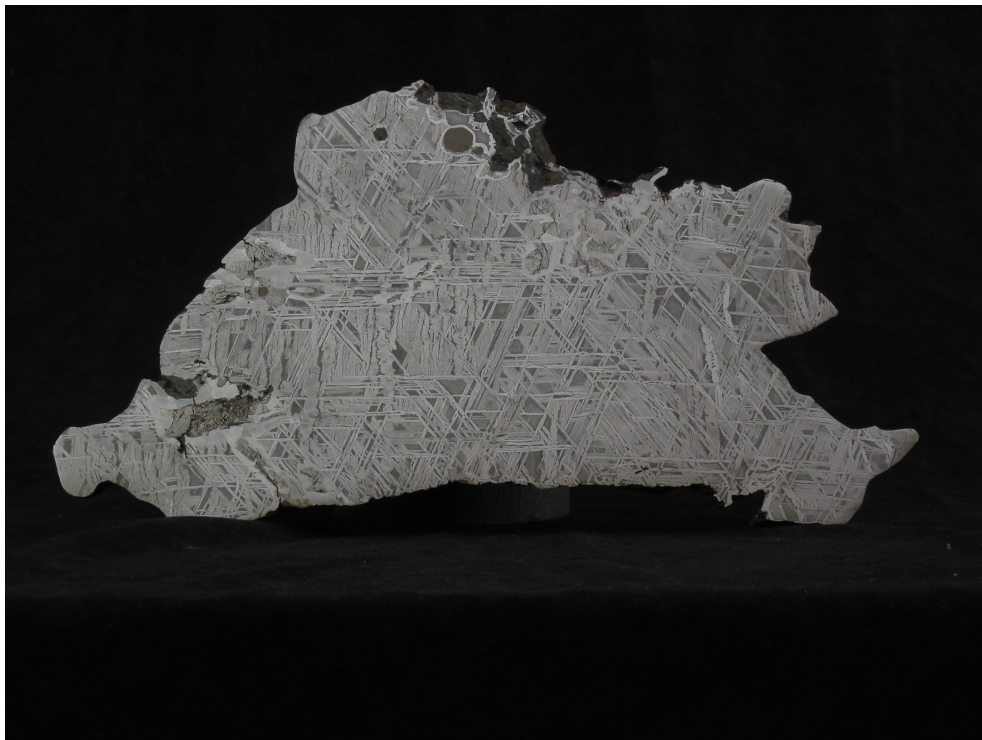
Abbildung 2.4: Eisenmeteorit mit angeätzter Oberfläche. Erkennbar ist das WIDMANNSTÄTTEN-Muster. Foto: A. Pack, Th. W. Schönbeck, D. C. Hezel
