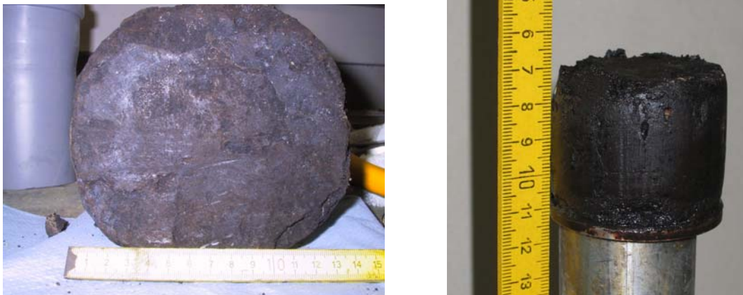
Abb. 15: Für die spezifische Permeabilitätsmessung ausgewähltes Probenmaterial der Bohrung HB11-03; Tiefe 1,00-1,035 m; rechts wassergesättigte Probe nach Durchführung des Versuches.
