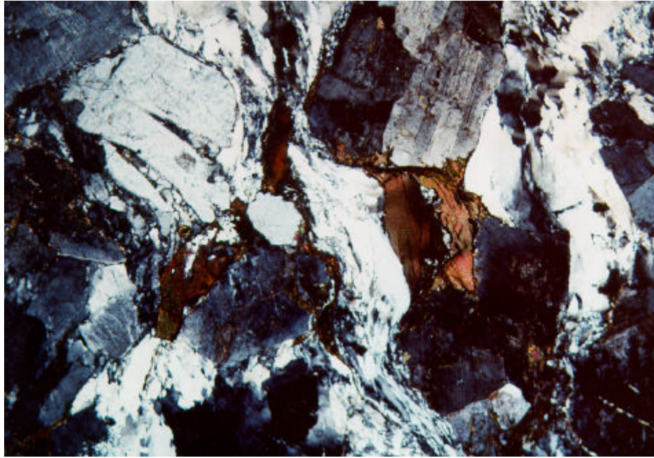
Abb. 6.1-1: Probennr. 19b (Gneis) im XPL.
