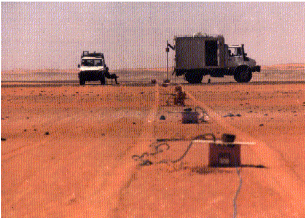
Abb 8-2: Mobiles Fallgewicht als seismische Quelle und Remote Units als Bestandteil der Seismik-apparatur.
