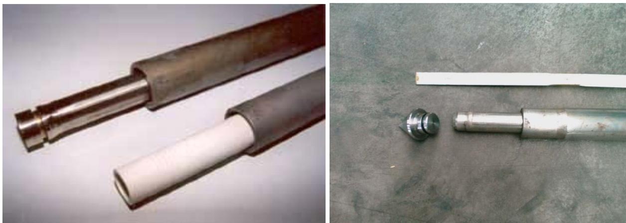
**Abbildung 15: Edelstahl- sowie PVC-Filter zur Grundwasserbeprobung mit Schutzgestänge (links), aus dem Sondiergestänge herausgedrückter Filter mit „verlorener“ Sondierspitze (rechts)**
