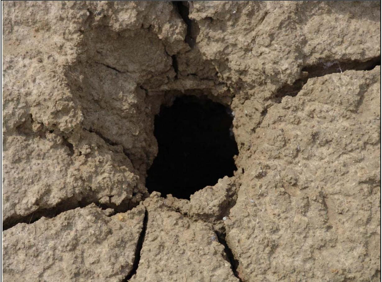
**Abbildung 40: Dampfdurchbruch entlang einer kanalartigen Druckentlastungsöffnung bis zur Erdoberfläche (Durchmesser: 12 cm)**
