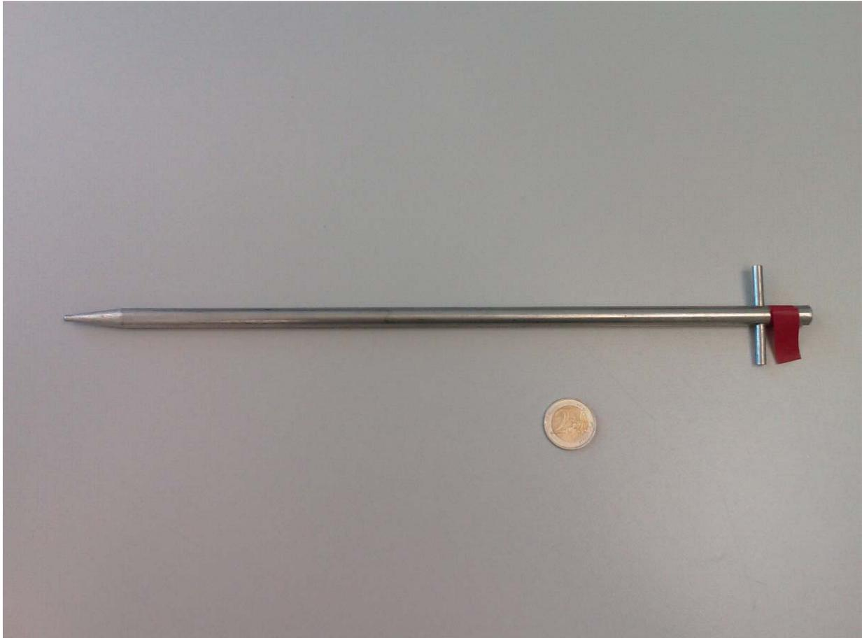
**Abbildung 42: Elektrodenstange für oberflächengeoelektrische Messungen**
