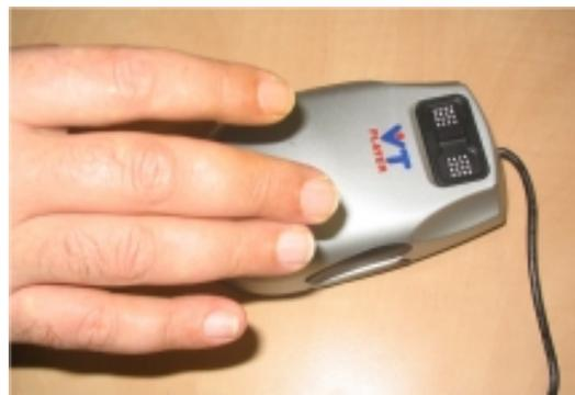
Abb. 3.2-4: Das virtuelle taktiler Display VTPlayer™ von VIRTOUCH (2003)
