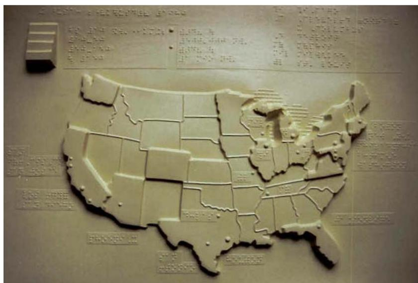
Abb. 5.3.2.1.2-3: Die taktile Variable Höhe – Realisierung mehrere Höhenstufen mit dem Thermo-Vakuüm-Verfahren auf PVC-Folie.
