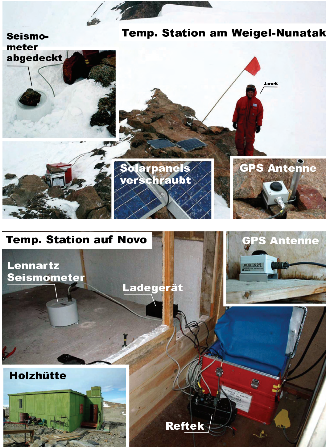
Abbildung 1.3-5: Temporäre Stationen am Weigel-Nunatak und auf Novo. Die Stationen operierten über den polaren Winter 2004/2005. Auf Novo wurde das Seismometer in einer Holzhütte auf einen Betonsockel gestellt, der ehemals für die Messung der absoluten Schwere errichtet wurde. Die Spannungsversorgung erfolgte über einen Laderegler, der an das Stationsnetz angeschlossen worden war. Das Seismometer am Weigel-Nunatak wurde auf gegründetem Fels aufgestellt und mit einem Eimer als Windschutz abgedeckt. Zwei mit Schrauben am Nunatak befestigte Solarpanels luden die Akkus bis zur Polarnacht auf.
