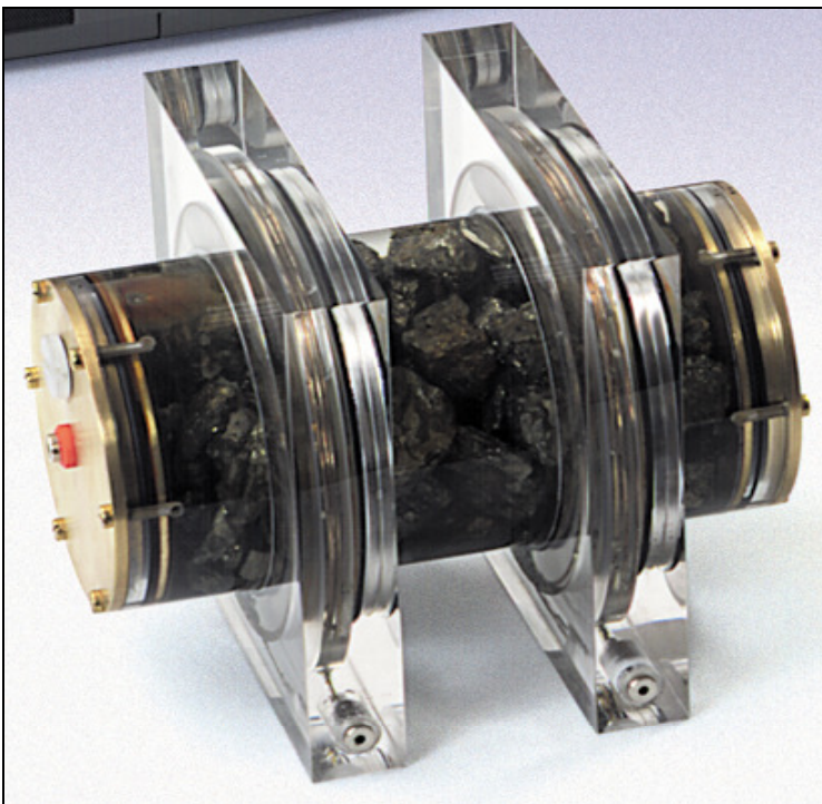
Abb. 7.2.1.2: Foto der für die Messungen optimierten Messzelle. Im Probenraum befinden sich grobe polykristalline Pyrit-Mineralen.
