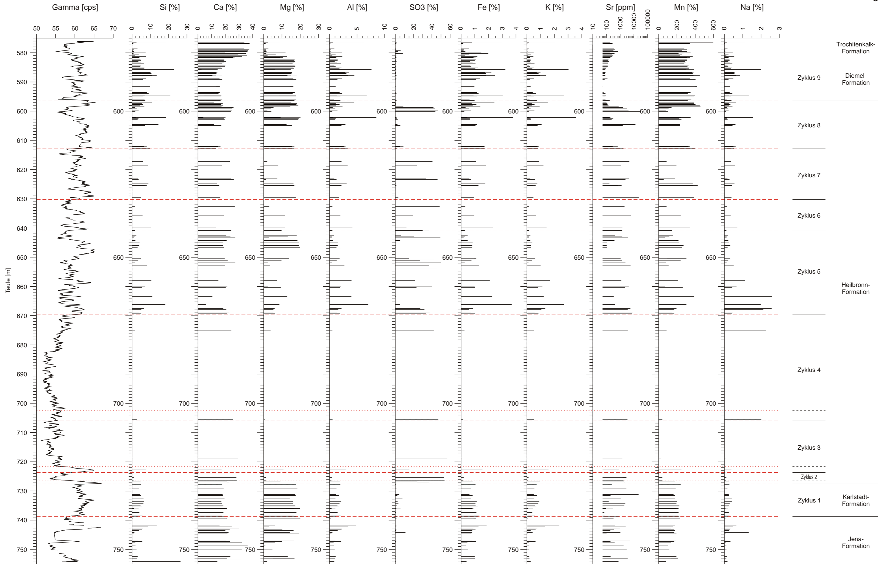
Gehalte der Elemente Si, Ca, Mg, Al, SO 3 , Fe, K, Sr, Mn, Na im Mittleren Muschelkalk der Bohrung Remlingen 7
