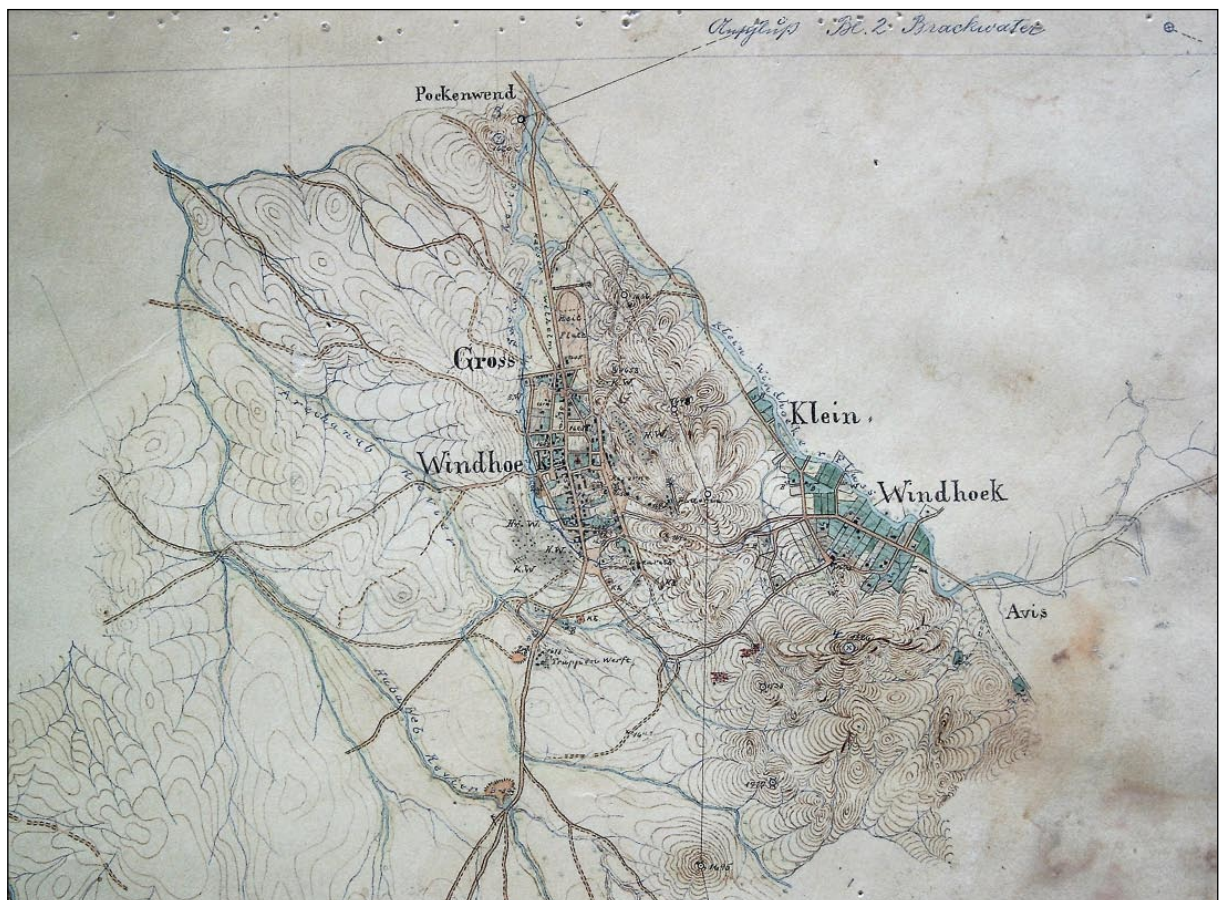
Bild 44: Frühe Messtischaufnahme der Kaiserlichen Landesvermessung von DSWA im Maßstab 1:50 000. Ausschnitt aus Blatt 1 Windhoek, 1901. Aufgenommen durch Topograph Karsunke (NNA, Kartensammlung Nr. 1529).
