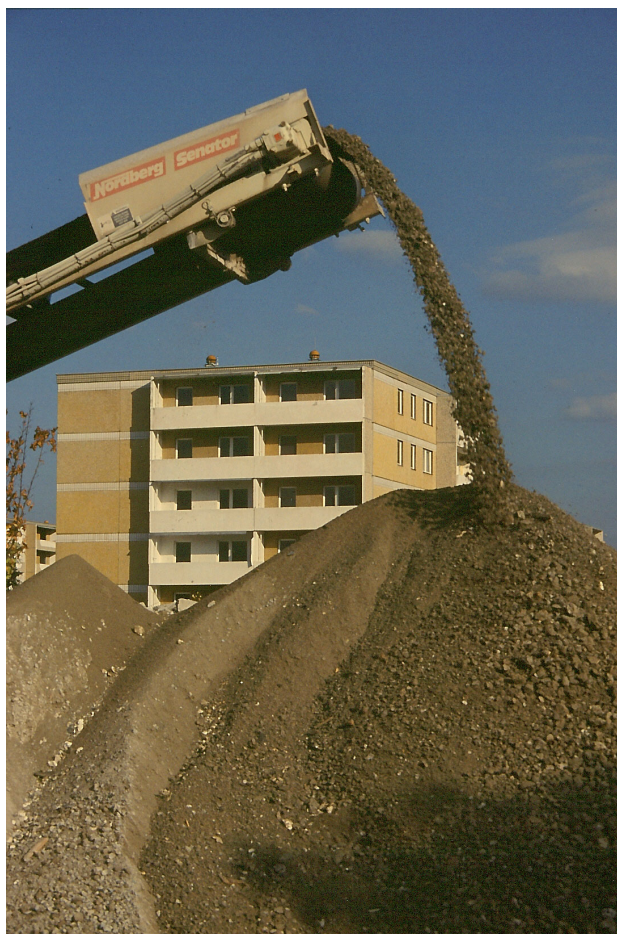
Foto 15: Maschinelle Zerkleinerung zu Feinschotter
