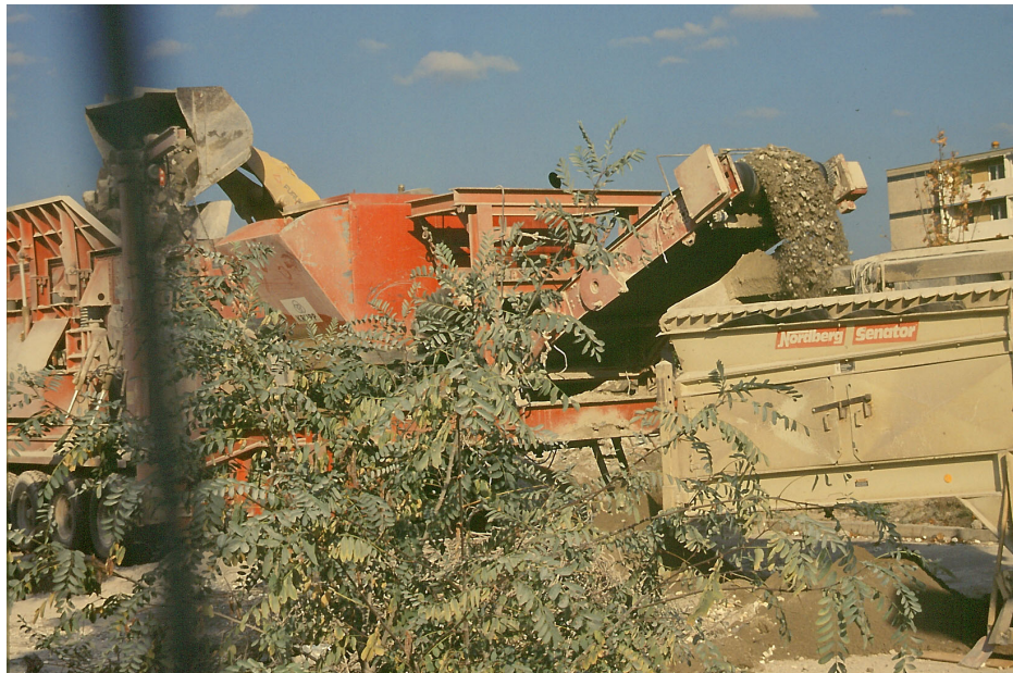
Foto 15: Maschinelle Zerkleinerung zu Feinschotter
