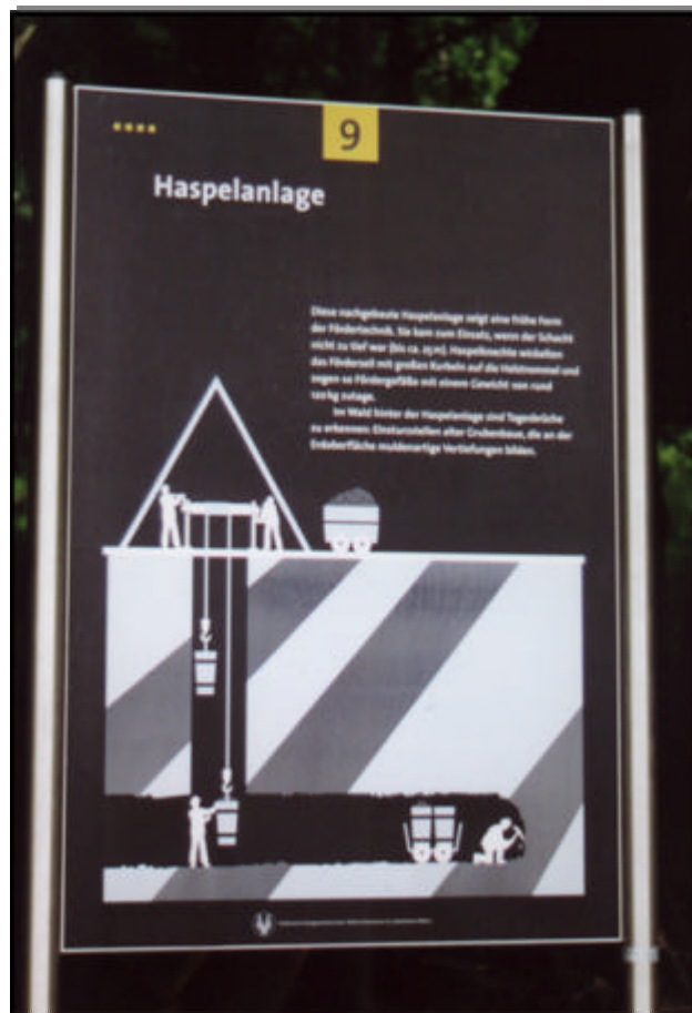
Abbildung 17: Erläuterungstafel der Haspelanlage (Foto M.D.)
