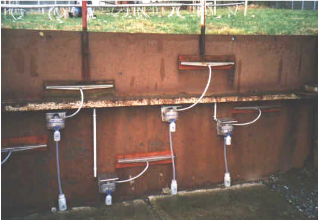
Bild A 5.3: Horizontblech mit Kippzähler auf Versuchsstation 1a
