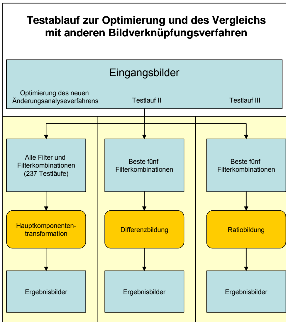
Abbildung 9.1: Arbeitsschema der Optimierung des Veränderungsanalyseverfahrens und des Vergleichs mit anderen Bildverknüpfungsmethoden
