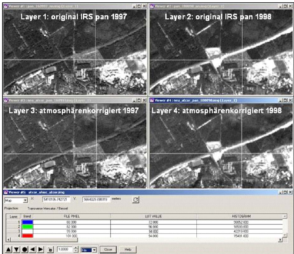
Abbildung 6.1: Bildausschnitte und Grauwerte der panchromatischen Daten vor und nach erfolgter Atmosphärenkorrektur (eigene Darstellung)
