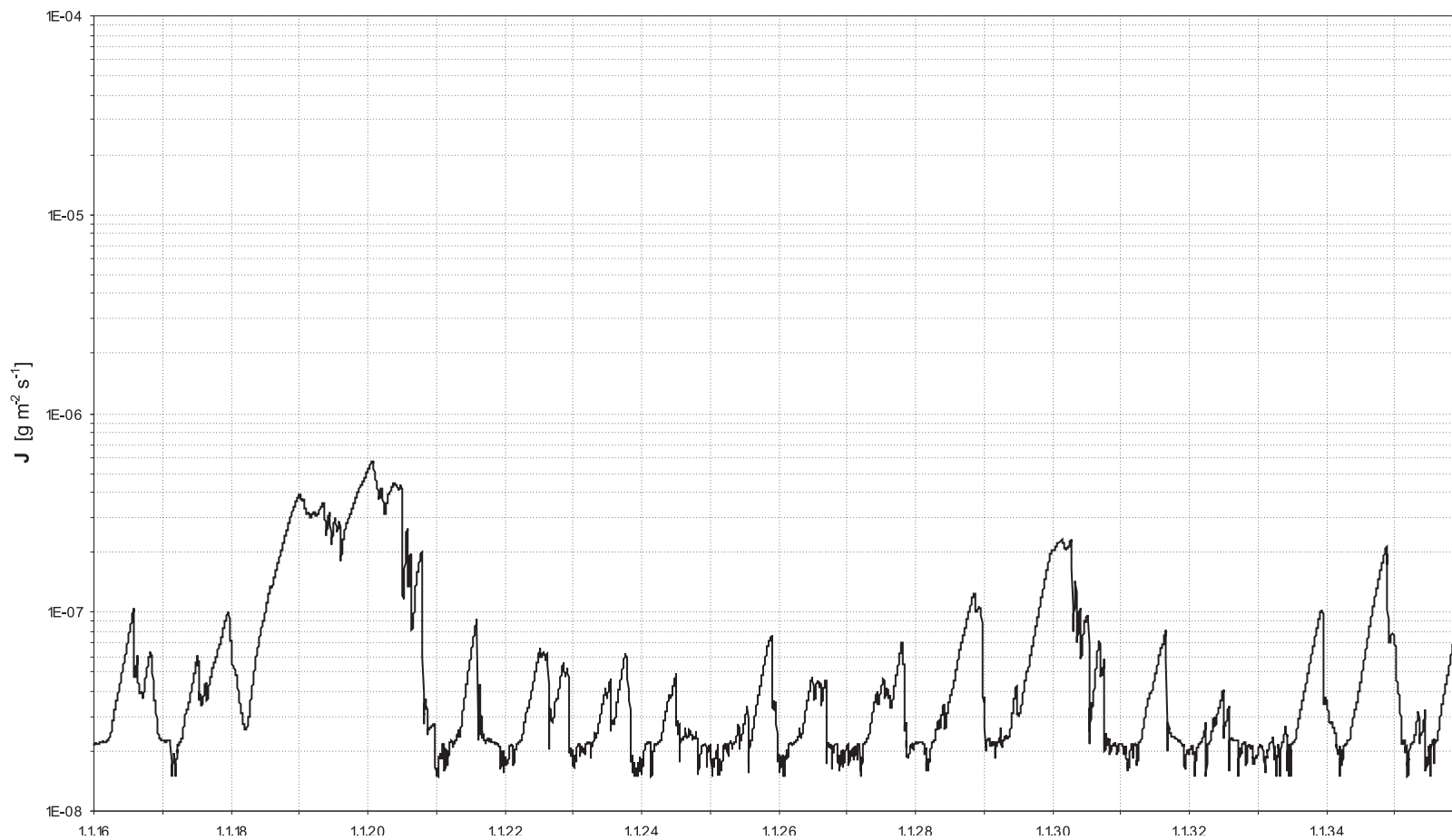
Abb. J41: Sauerstoffdiffusion ( D_{eff} nach ELBERLING), Versuchsfeld 2, Szenario „Klimaentwicklung I“, langjährige Reihe 1.1.2016–31.12.2035. Sättigungsverhältnisse aus HYDRUS_2D-Simulation, Abb. I47.
