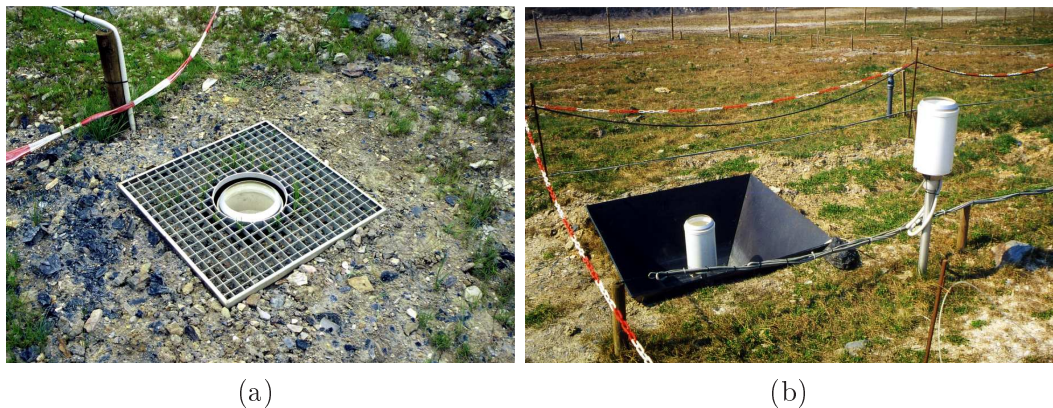
Abb. 4.24: Niederschlagsmessung auf der Versuchsanlage Lichtenberg: (a) Bodengleiche Messung bis November 2001; (b) Vergrößerte Meßgrube ab Winterhalbjahr 2001/2002 und Sammler in 1 m Aufstellhöhe.
