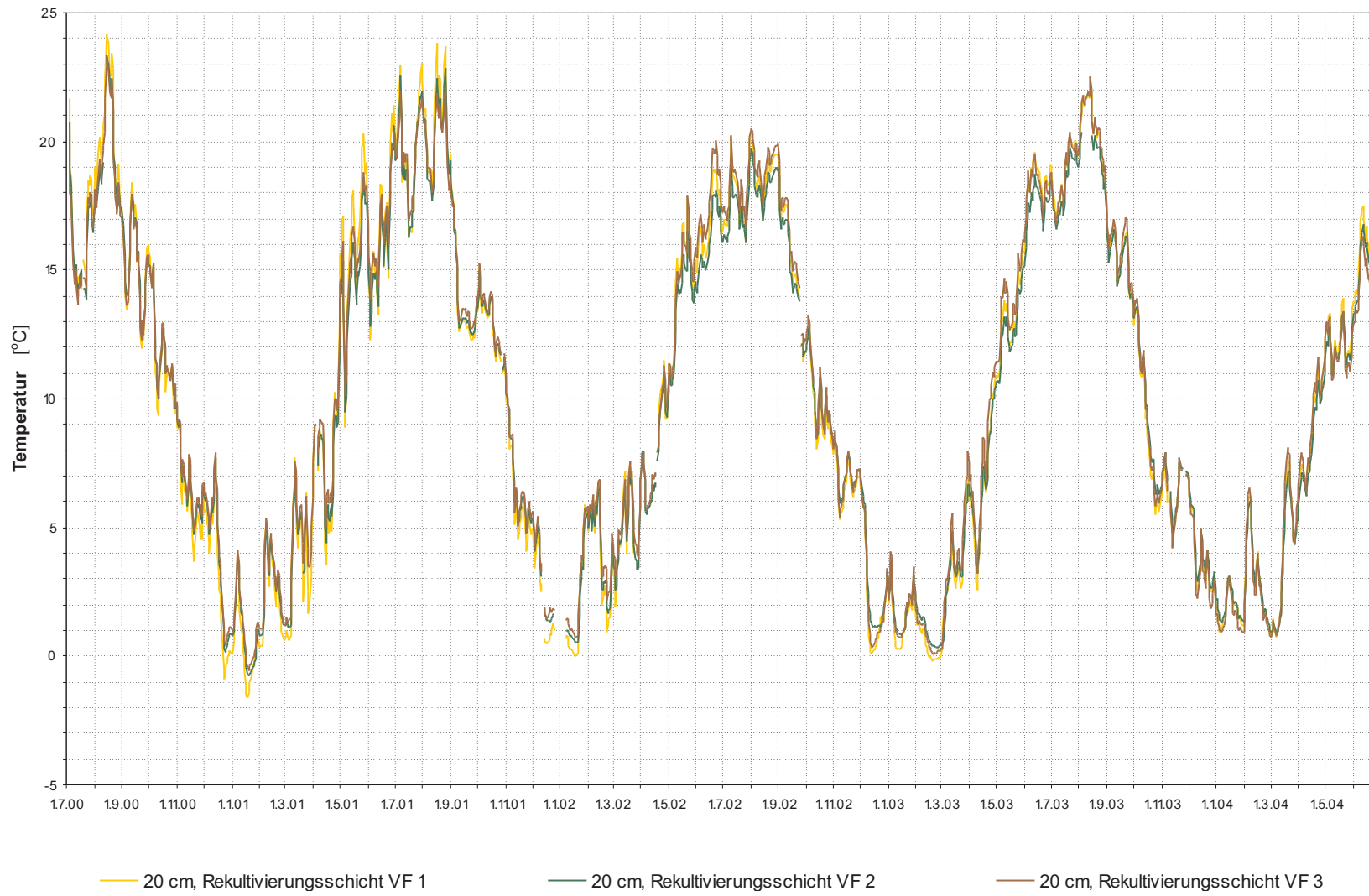
Abb. D5: Vergleich der Oberbodentemperaturen: Bodentemperaturen auf den Versuchsfeldern 1–3, 20 cm Bodentiefe (Tagesmittelwerte).
