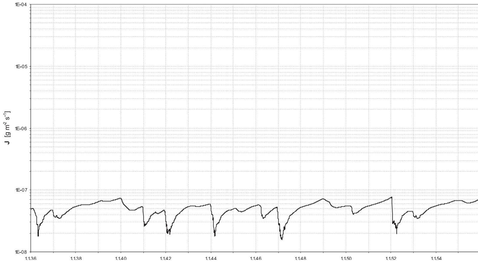
Abb. J19: Sauerstoffdiffusion ( D_{eff} nach ELBERLING), Versuchsfeld 1, Szenario „Klimaentwicklung II“, langjährige Reihe 1.1.2036–31.12.2055. Sättigungsverhältnisse aus HYDRUS_2D-Simulation, Abb. I38.
