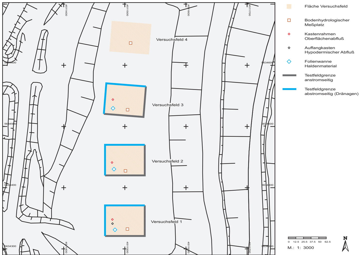
Abb. A1: Übersichtsplan Versuchsanlage Lichtenberg: Lage der Versuchsfelder und Meßplätze
