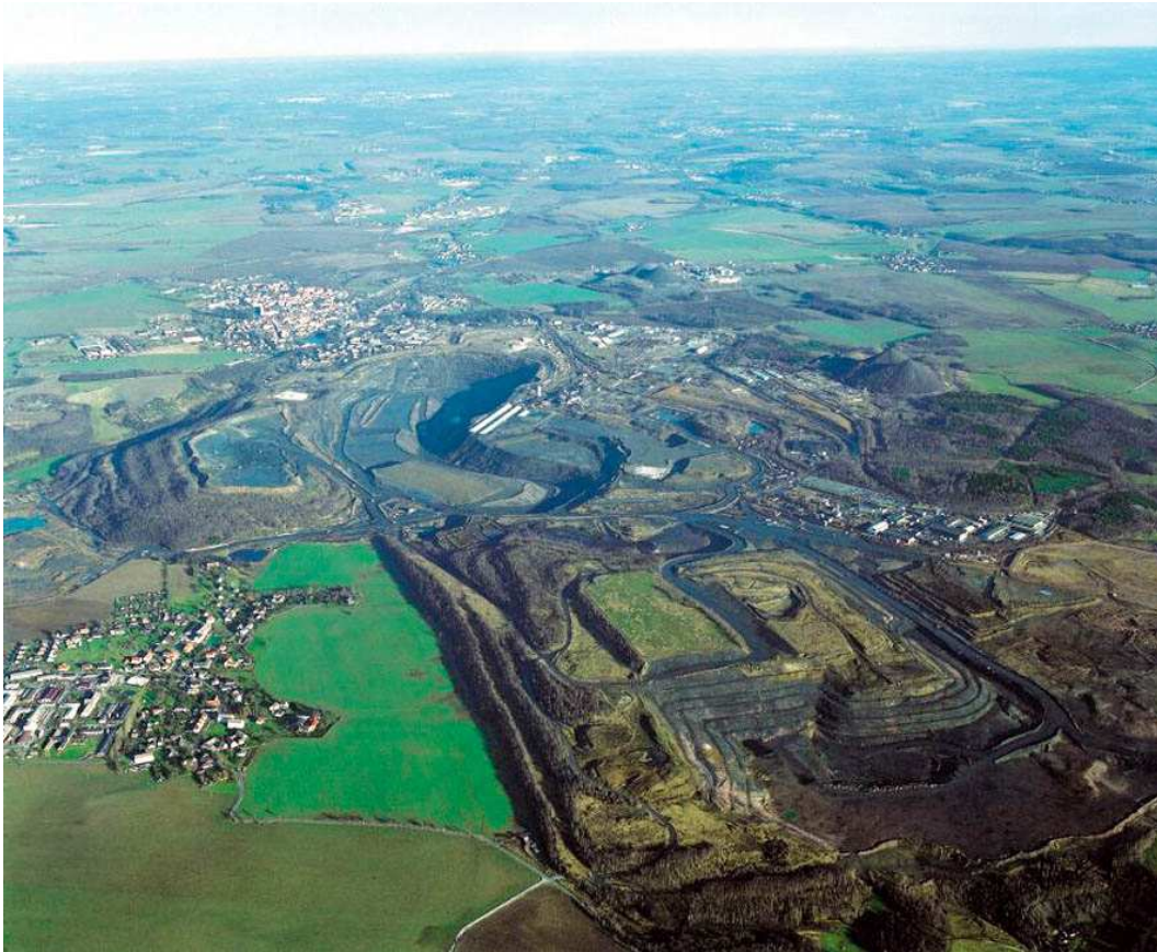
Abb. 3.3: Luftbild vom südlichen Ronneburger Revier, Dezember 1998, Blickrichtung Nordost. Im Vordergrund die sich im Abtrag befindende Absetzerhalde und die Ortschaft Kauern; in der Bildmitte die Nordhalde (begonnender Abtrag), das bereits teilweise verfüllte Tagebaurestloch Lichtenberg sowie die Betriebsgelände Schmirchau und Reust und die Spitzkegelhalden Reust; im Bildhintergrund die Ortschaft Ronneburg sowie die Spitzkegelhalden Paitzdorf.
