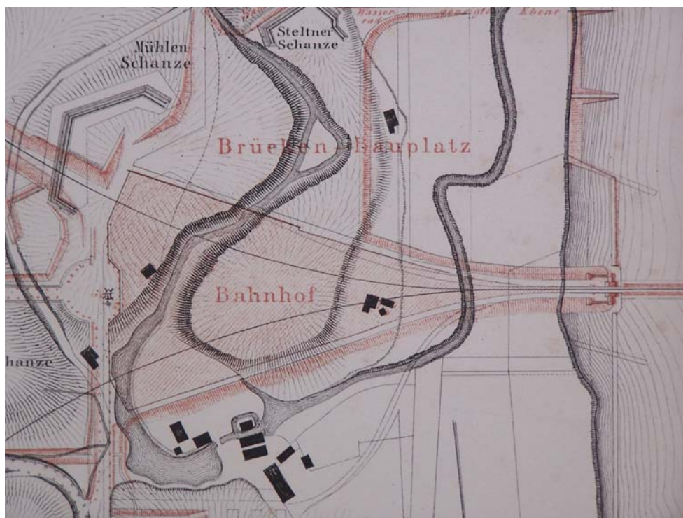
Abb. 2.4: Situations-Plan von Dirschau: mit der projektierten Weichselbrücke in der Berlin-Königsberger Eisenbahnlinie, 1 : 5000, ca. 1850. Die Abbildung zeigt den Plan der Brückenbauarbeiten an der Weichsel. Auf einer schwarzen Basiskarte sind die projektierten Teile des Bauwerkes sowie die für die Ausführungsarbeiten notwendigen Infrastrukturen wie Lagerplätze und Fertigungsplätze von nur temporärem Bestand in sepia dargestellt.
