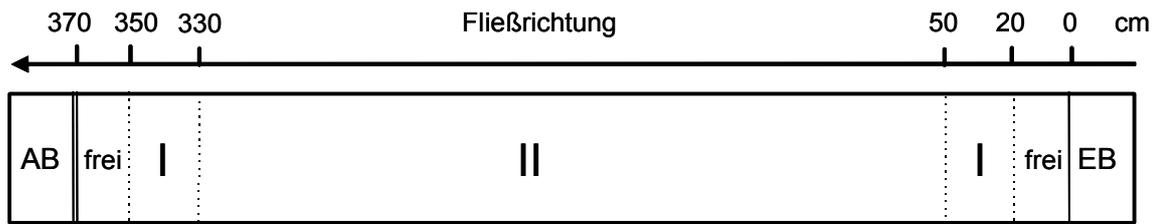
Abb. 6: Schematische Darstellung der Verteilung des Sedimentes. AB: Auffangbecken, EB: Einströmbecken, I: Sediment der Größenklasse  $\varnothing$  8-16 mm, II: Sediment der Größenklassen  $\varnothing$  2-8 mm (46%),  $\varnothing$  8-16 mm (31 %) und  $\varnothing$  16-32 mm (23%), frei: kein Sediment.
