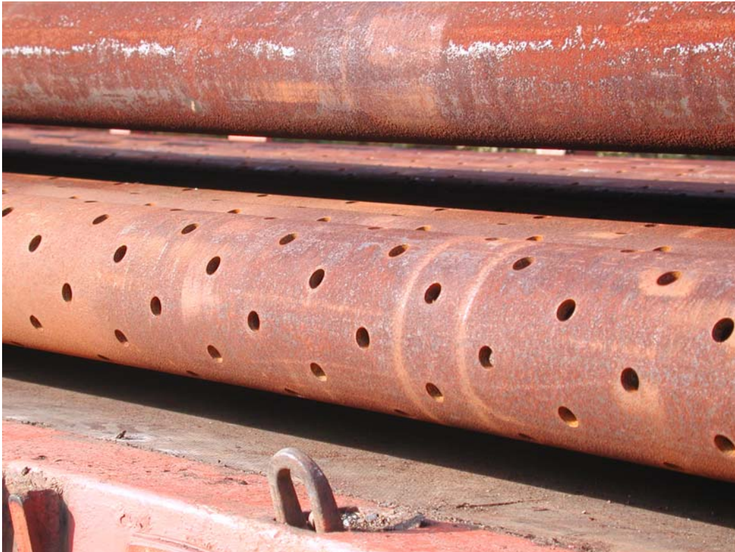
Bild 4.3.1: Gelochter Liner, eingesetzt im Teufenbereich 4135 - 4305 m.
