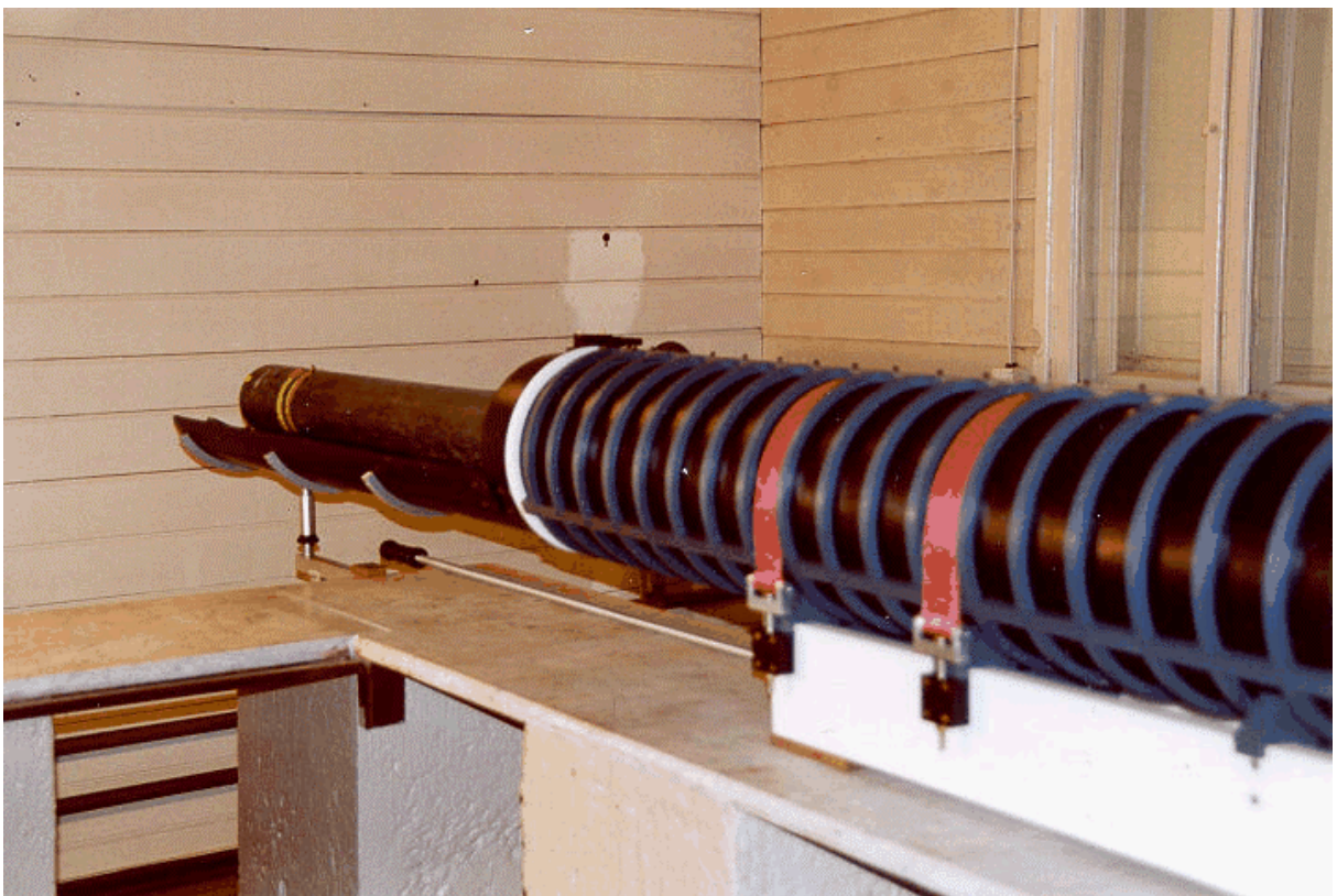
Abb. 16 Kalibrierspule komplett montiert im Magnetischen Labor mit Induktionsspule
