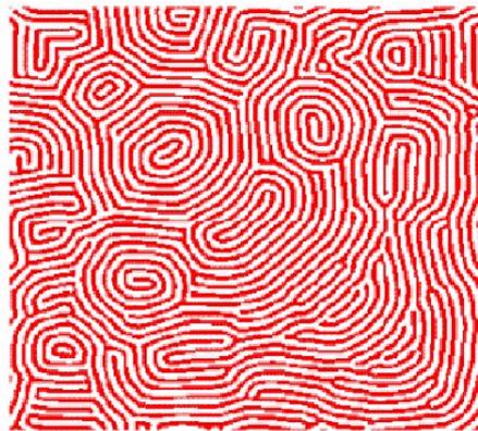
Abbildung 3 Bénardzellen. Das Bild zeigt das Temperaturfeld in einer horizontalen Flüssigkeitsebene. Auch wenn sich das Bild irregulär verändert, bleiben die spiralförmigen Konvektionsrollenstrukturen dauerhaft. (Quelle: <http://www.uni-muenster.de/Physik/DEK/FB-Brosch/TP4.jpg>, 17.2.2003)
