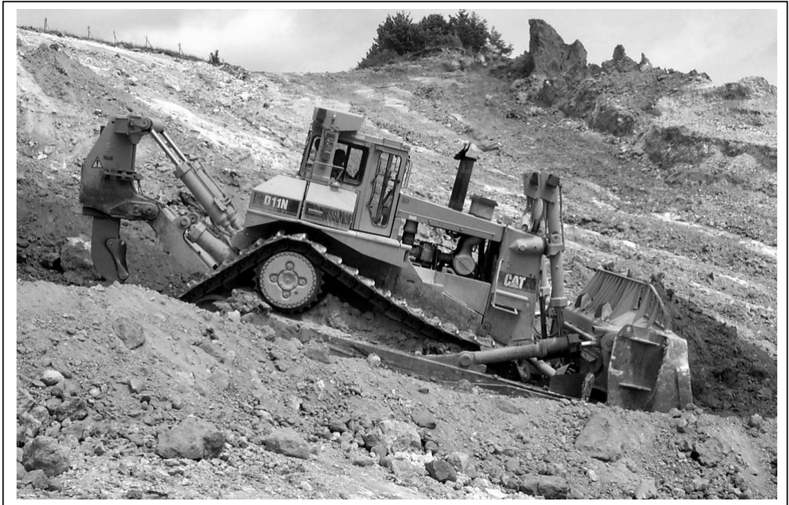
Abbildung 15: Reißbraupe bei einer Neigung von 30% (Foto: P. Schmieder)
