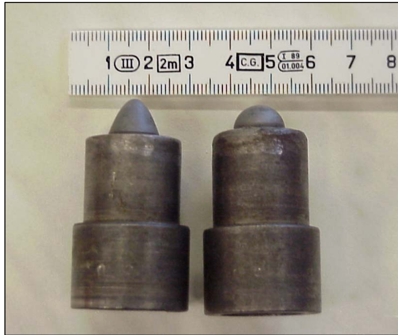
Abbildung 4.8: Bei den Versuchen verwendete Zahnformen, links ballistischer Zahn, rechts sphärischer (Kugel-)Zahn
