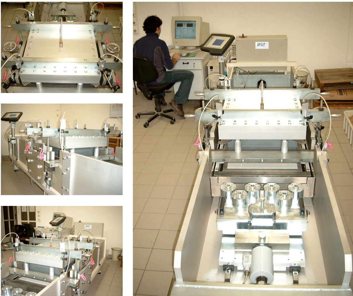
Abbildung 3.2: Geosynthetik-Boden-Interaktionsprüfgerät (IPG) des Instituts für Geotechnik der TU Bergakademie Freiberg
