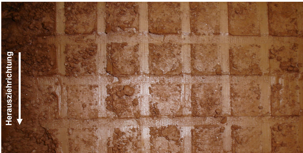
Abbildung 6.15: Detailaufnahme der Herausziehebene nach dem Versuch
