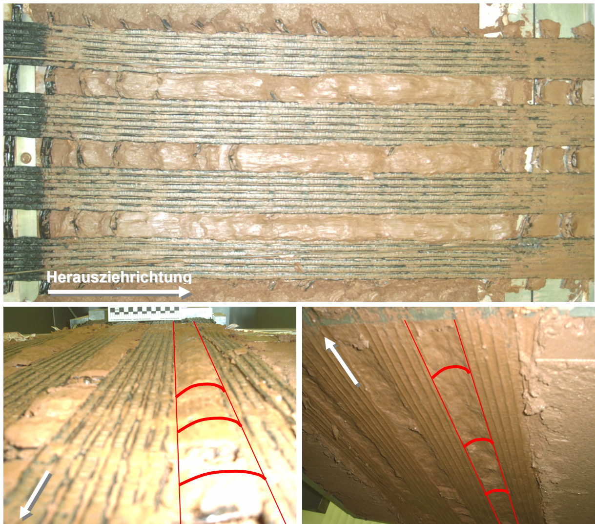
Abbildung 6.11: Lastabtragungsmechanismus des PVA-Geogitters (G.we.750)
