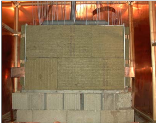
Abb. A8 Einrichtungen zur Bodenluftabsaugung und Führungsschläuche für die faseroptischen Temperatursensoren am Technikumsreaktor T2
