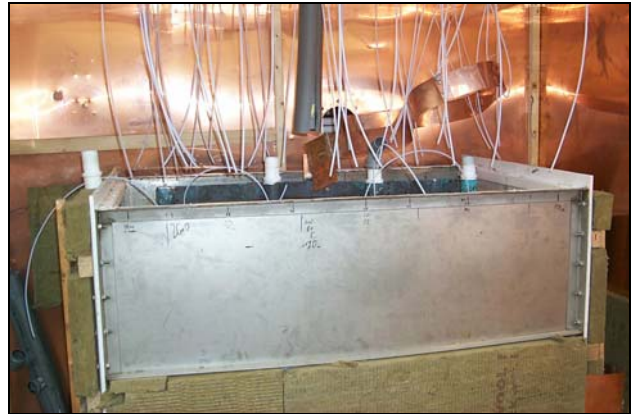
Abb. A8 Einrichtungen zur Bodenluftabsaugung und Führungsschläuche für die faseroptischen Temperatursensoren am Technikumsreaktor T2
