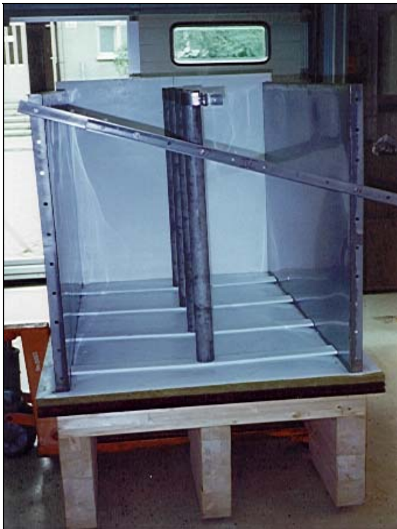
Abb. A9 Technikumsreaktor mit vier stabförmigen Elektroden, die mittig als Reihe angeordnet sind und in der Regel als „heiße“ Elektroden genutzt wurden (nach der Konstruktion [ links ] und nach der Durchführung eines Langzeitversuches mit kontaminiertem Originalboden [ rechts ])
