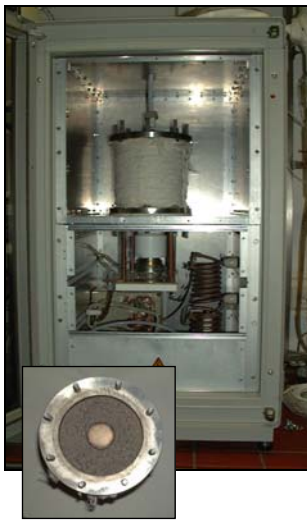
Abb. 7 Zylindrischer Bodenreaktor ( unten ) und eingebauter Reaktor mit Matchbox im unteren Teil des Abschirmgehäuses ( großes Bild )
