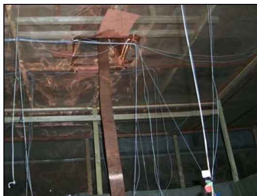
Abb. 21 Position der Matchbox mittig oberhalb der HF-Versuchsmiete ( links ), Verlauf des Kupferbandes zur Kontaktierung der oberen Elektrode ( Mitte ) und modifizierte Matchbox zur parallelen Einspeisung von HF- und NF-Energie ( rechts )
