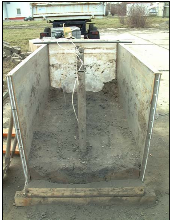
Abb. A9 Technikumsreaktor mit vier stabförmigen Elektroden, die mittig als Reihe angeordnet sind und in der Regel als „heiße“ Elektroden genutzt wurden (nach der Konstruktion [ links ] und nach der Durchführung eines Langzeitversuches mit kontaminiertem Originalboden [ rechts ])
