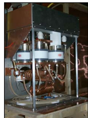
Abb. 21 Position der Matchbox mittig oberhalb der HF-Versuchsmiete ( links ), Verlauf des Kupferbandes zur Kontaktierung der oberen Elektrode ( Mitte ) und modifizierte Matchbox zur parallelen Einspeisung von HF- und NF-Energie ( rechts )
