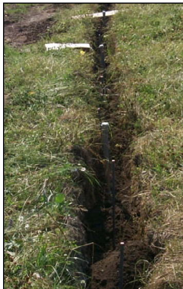
Abb. A12 Versuchsfeld für die Erprobung der Koaxialantennentechnik zur HF-Bodenerwärmung am UFZ Leipzig ( links : Graben mit Führungsrohr für das Koaxialkabel; Mitte : Graben mit Röhrchen für Temperatursensoren; rechts : Oberfläche des Antennenbereiches mit Temperatur- und Feuchtemesstechnik)
