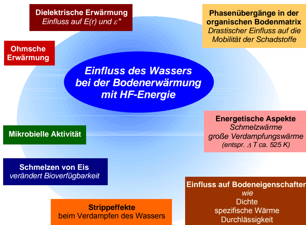
Abb. 50 Effekte und charakteristische Parameter bei der Hochfrequenz-Bodenerwärmung, die durch die Feuchte bestimmt werden
