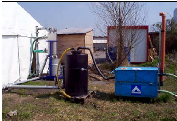
Abb. A13 Anschluss der Filterbrunnen an die Bodenluftabsaugung ( oben ), Wasserabscheider und Gebläse ( links ) und Aktivkohlefilter ( rechts ) als Bestandteile der konventionellen BLA
