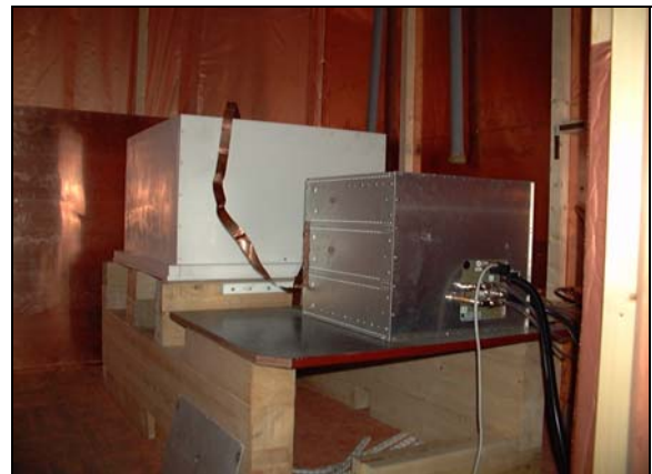
Abb. A7 Bodenbettreaktor T1 für Untersuchungen zur Radiowellen-Erwärmung im kleintechnischen Maßstab mit elektronischem Anpassnetzwerk und thermischer Isolierung, installiert in einer Umhausung aus Kupferblech zur elektromagnetischen Abschirmung
