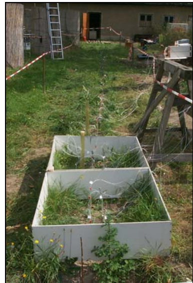
Abb. A12 Versuchsfeld für die Erprobung der Koaxialantennentechnik zur HF-Bodenerwärmung am UFZ Leipzig ( links : Graben mit Führungsrohr für das Koaxialkabel; Mitte : Graben mit Röhrchen für Temperatursensoren; rechts : Oberfläche des Antennenbereiches mit Temperatur- und Feuchtemesstechnik)
