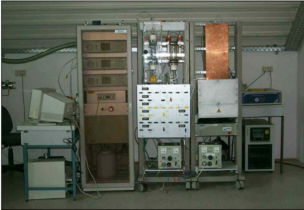
Abb. A6 Laborversuchsanlage zur Untersuchung von mikrobiellen Abbauprozessen unter dem Einfluss unterschiedlicher Heizmethoden (konventionell mittels Wasserbad, ohmsch mittels Niederfrequenz-Anwendung und dielektrisch mittels Radiofrequenz-Anwendung)
