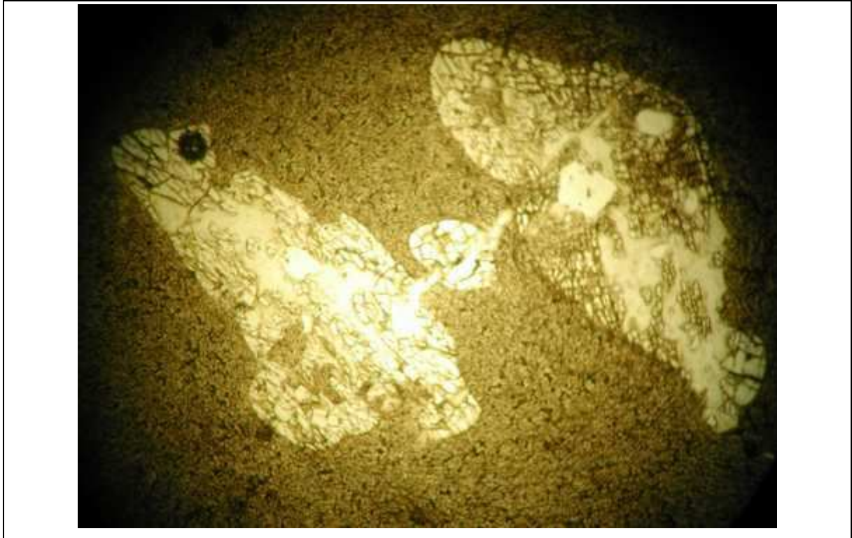
Abbildung A18: Detail angelöste Restkristalle (Pyroxen, Vergrößerung 10-fach) Schmelzbasalt Probe 1406-2
