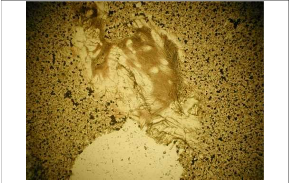
Abbildung A14: Detail Restkristall Titan – Augit (a), Pore (b) (Vergrößerung 20-fach), Schmelzbasalt Probe 1306-3
